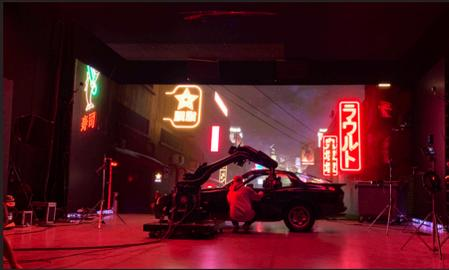
Les décors sont projetés sur des écrans Led, en second plan, construits dans un logiciel 3d utilisé par les créateurs de jeu Vidéo ( Unreal Engine/Epic Games ). Nous filmons avec une caméra équipée d'un système de tracking qui communique directement avec notre logiciel 3D. Le décor filmé réagit en fonction de la position de la caméra, nous gardons en permanence à l'image la perspective du décor, notre oeil est trompé, le décor devient réel.
